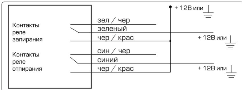
Схема подключения к двухпроводным приводам системы запирания
