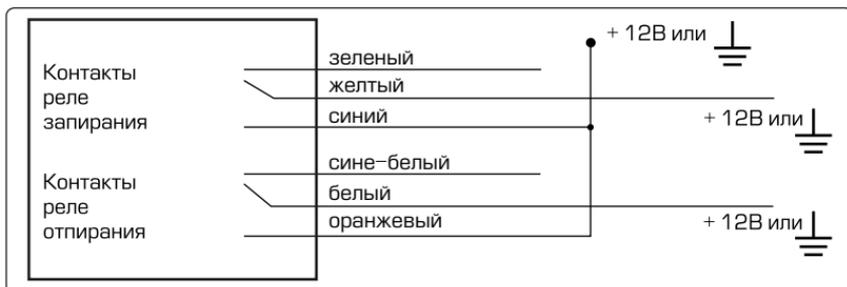
Схема подключения к двухпроводным приводам системы запирания
