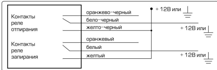
Схема подключения к двухпроводным приводам системы запирания
