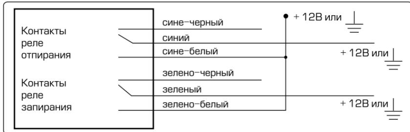
Схема подключения к двухпроводным приводам системы запирания
